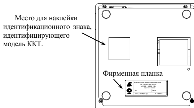
Рисунок 2 – Места маркировки машины и установки фирменной планки (вид на снизу).
